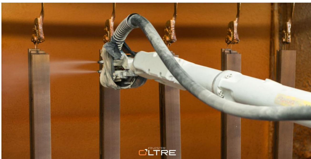
Fig. 3: Lui è "i-Giotto" il robot antropomorfo della DEAR: è capace di verniciare ogni singolo profilo delle Finestre OLTRE e usa solo vernici all'acqua, atossiche, ecosostenibili e con una garanzia di ben 20 anni.
