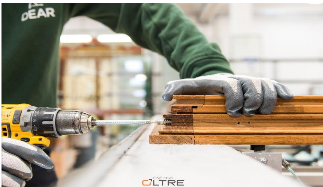
Fig. 2: accoppiamento dei profili (montanti e traversi) delle FINESTRE OLTRE con il sistema di giunzione angolare meccanica (priva di colle inquinanti) e l'apposizione di apposite viti per una maggiore durata dei prodotti.
