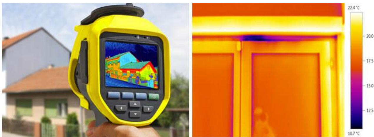
Fig. n. 2.6: Il blower-door test per la rilevazione dei ponti termici in cantiere, grazie a una camera ad infrarossi.
