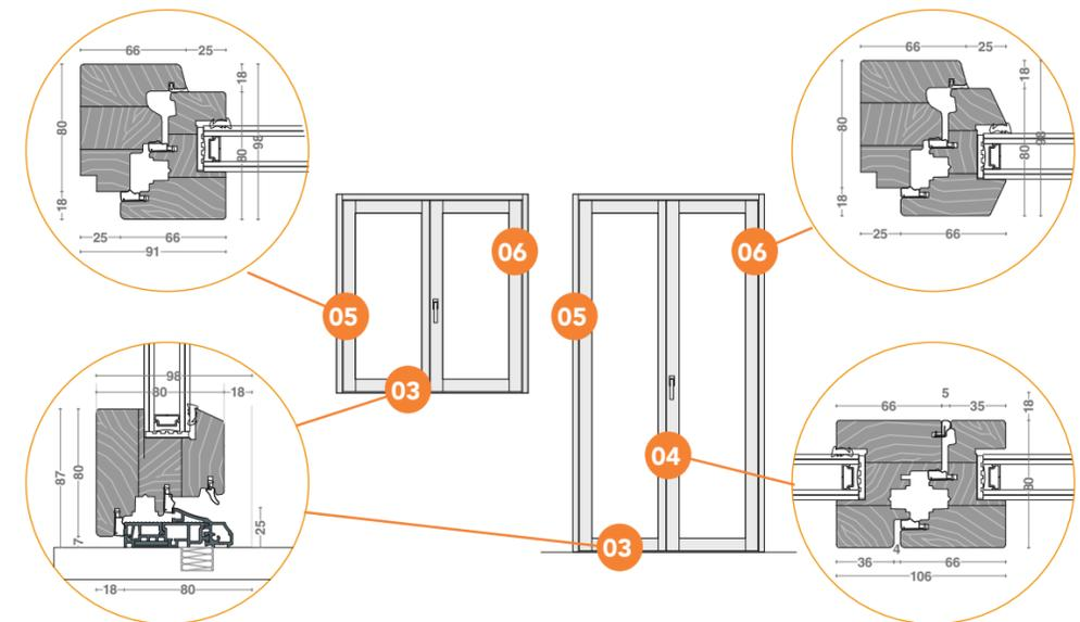
01 "Stile Pura" 02 "Stile Prisma" 03 Optional gocciolatoio in alluminio portafinestra disponibile anche per solo finestra 04 Nodo centrale unico asimmetrico 05 Optional telaio con **coprifili complanari stile Pura** 06 Optional telaio con **coprifili complanari stile Prisma**
