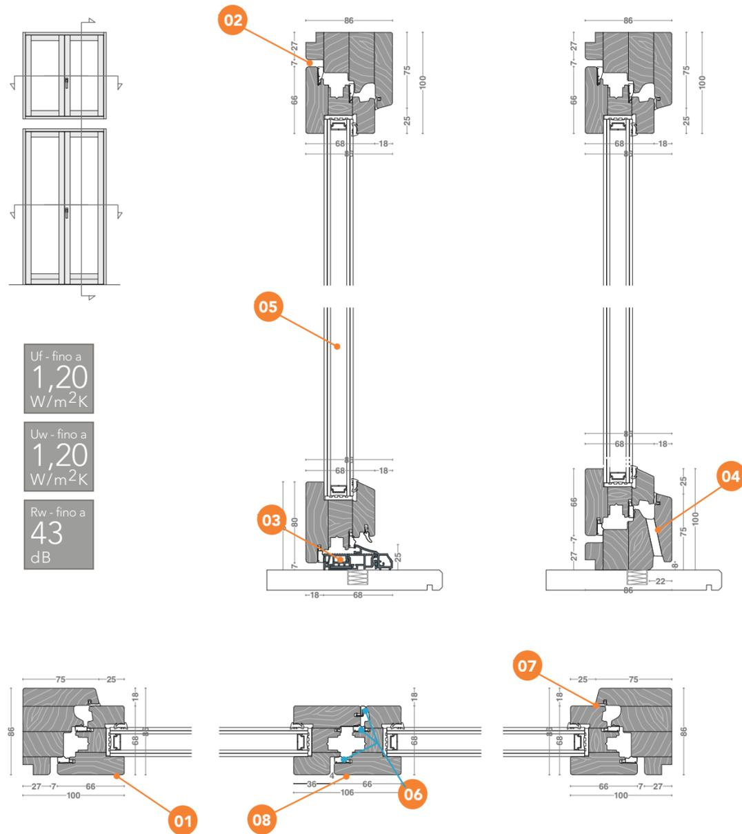
01 "Stile Pura" (profilo dritto) 02 "Plana" (anta e telaio complanari) 03 Soglia a taglio termico 04 Gocciolatoio in legno 05 Vetrocamera 06 Guarnizioni in polipropilene e schiuma uretanica 07 Guarnizioni in EPDM 08 Nodo centrale asimmetrico complanare
