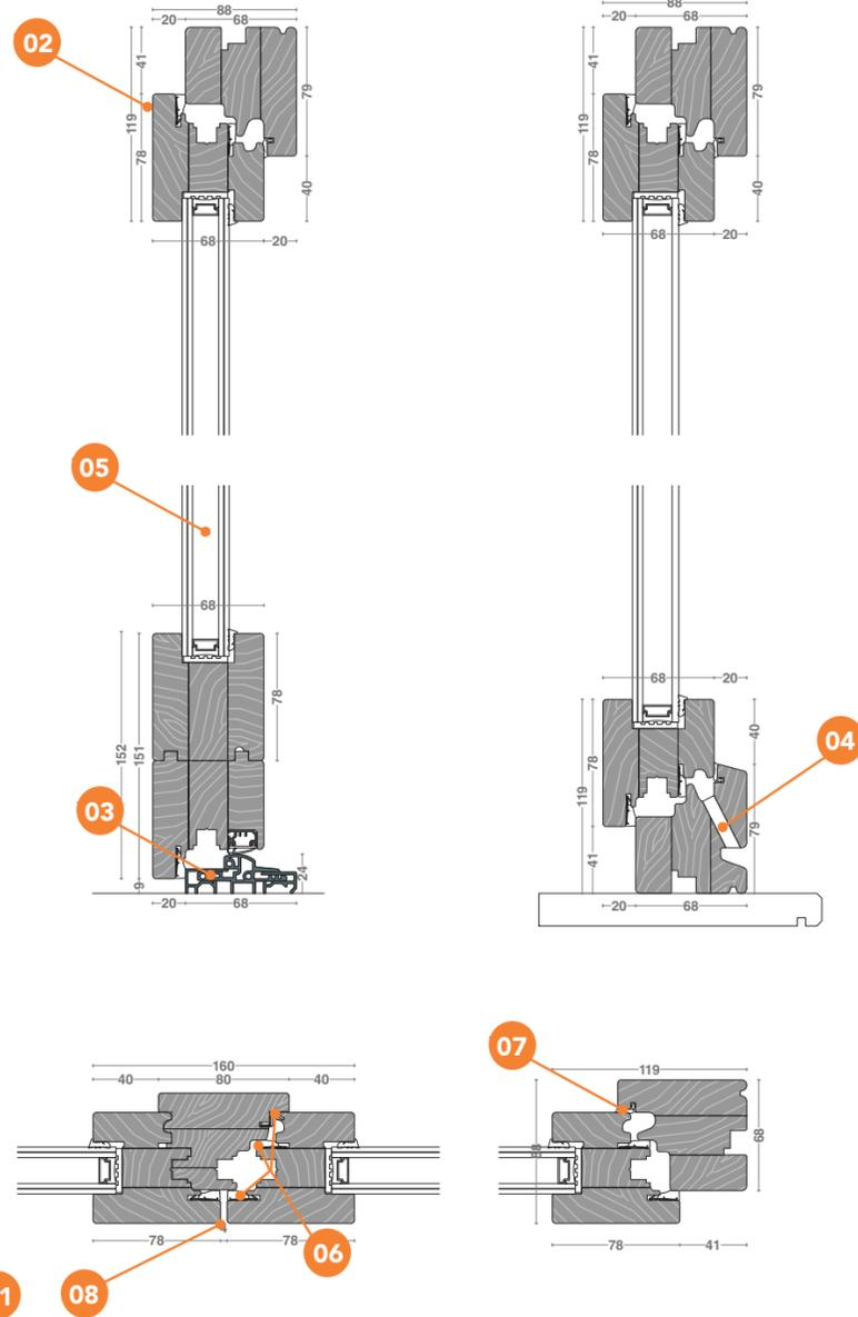
**01 "Stile Pura" (profilo dritto)** **02 "Standard" (anta e telaio sfalsati)** **03** Soglia a taglio termico **04** Gocciolatoio in legno **05** Vetrocamera **06** Guarnizioni in polipropilene e schiuma uretanica **07** Guarnizioni in EPDM **08** Nodo centrale simmetrico complanare
