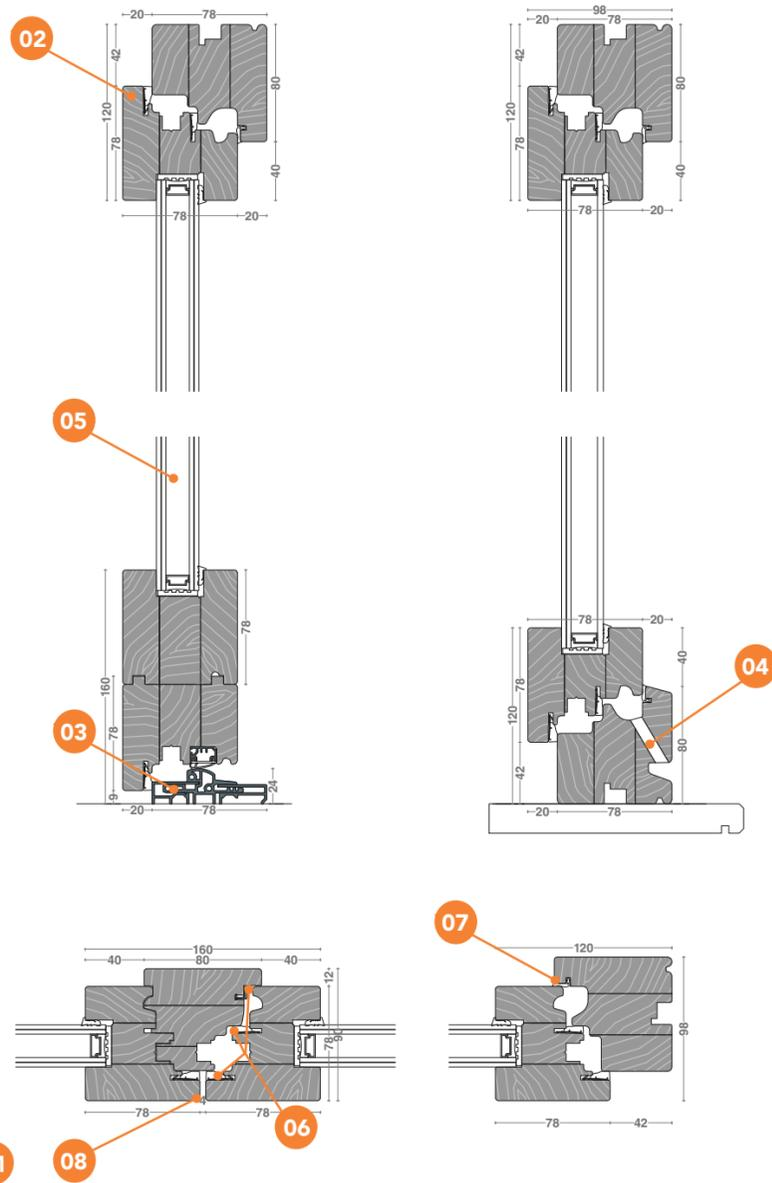
**01 "Stile Pura" ( profilo dritto ) 02 "Standard" ( anta e telaio sfalsati ) 03** Soglia a taglio termico **04** Gocciolatoio in legno **05** Vetrocamera con possibilità variante doppia camera **06** Guarnizioni in polipropilene e schiuma uretanica **07** Guarnizioni in EPDM **08** Nodo centrale simmetrico complanare
