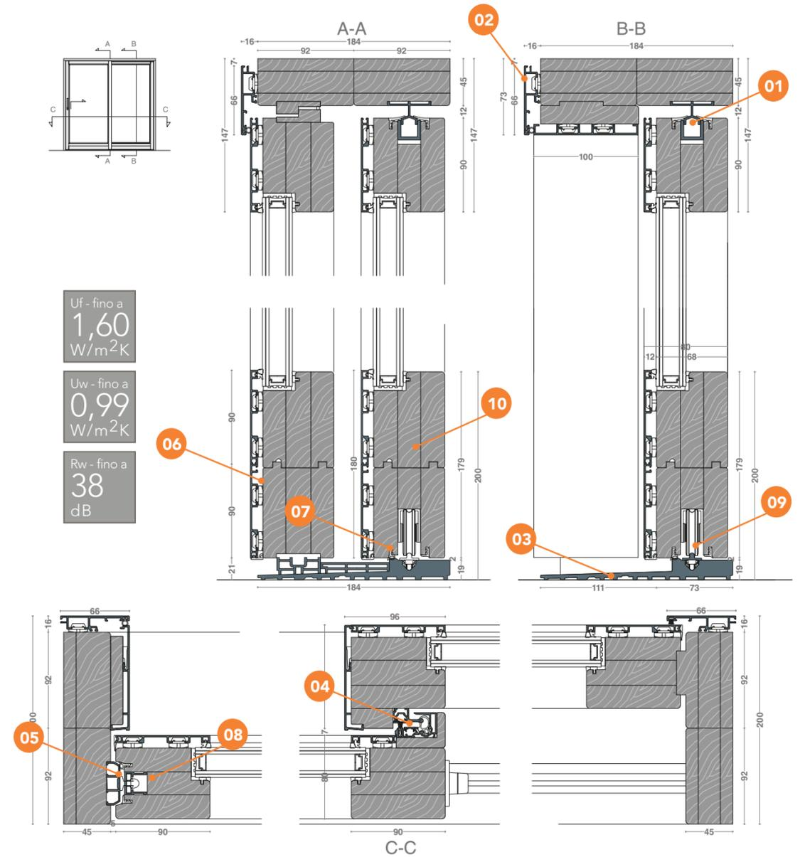
**01** Guida superiore a scomparsa **02** Profilo esterno in alluminio **03** Soglia termica in vetroresina **04** Profilo centrale in alluminio con rinforzo antieffrazione e guarnizione in EPDM **05** Profilo di chiusura laterale in alluminio con perni e registrazione di pressione **06** Profilo inferiore doppio in alluminio **07** Guarnizione in EPDM **08** Serratura a basso sforzo di manovra **09** Carrello ad alta portata ( max 450 Kg ) e basso attrito **10** Vetrocamera
